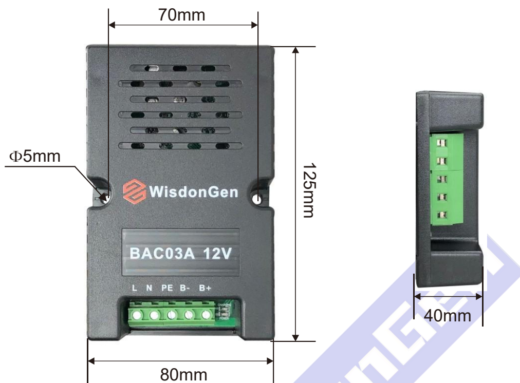
图3 BAC03 12V 安装尺寸图
